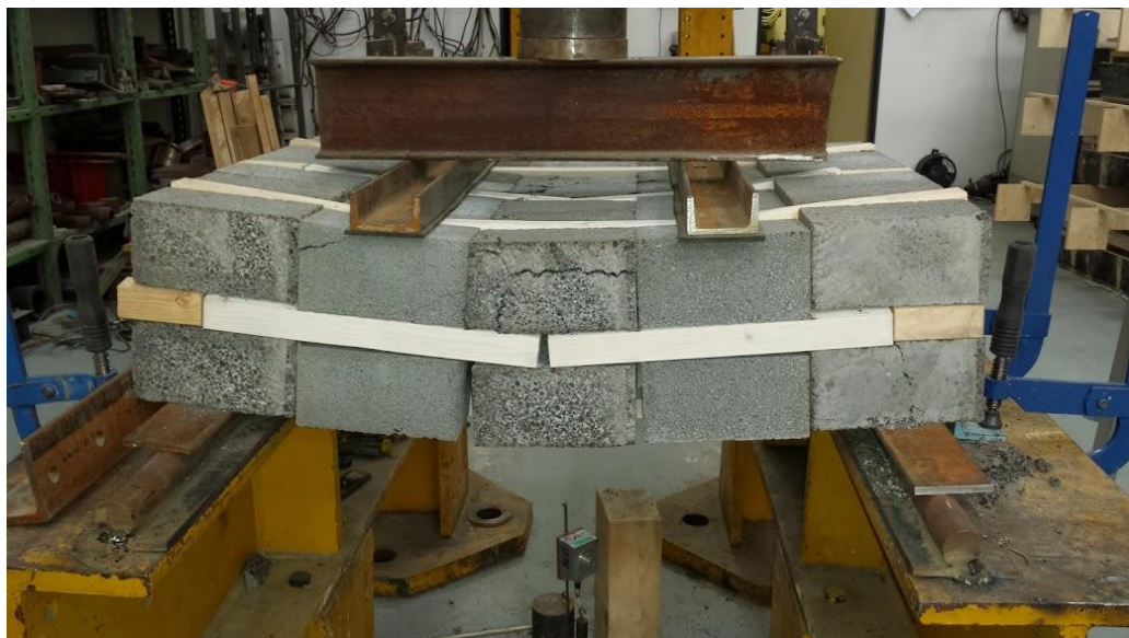
Obr. 4.7: Zatěžovací zkouška v rovině porušení rovnoběžné s ložnými spárami (A)
