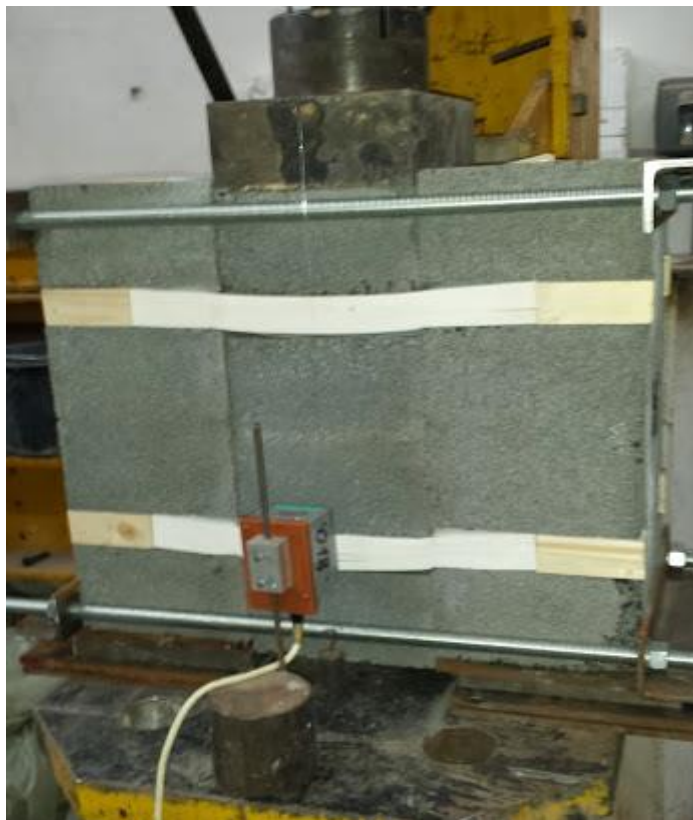
Obr. 5.3: Zatěžovací zdiva ve smyku
