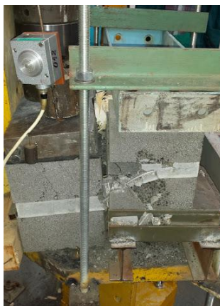
Obr. 6.3: Zatěžovací zkouška soudržnosti zdících prvků ve smyku
